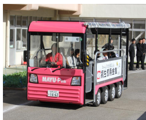
タイヤに注目 前から3輪(実際は6輪)が少しずつ角度を変えて動いています
