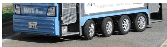
タイヤに注目 前から3輪(実際は6輪)が少しずつ角度を変えて動いています
